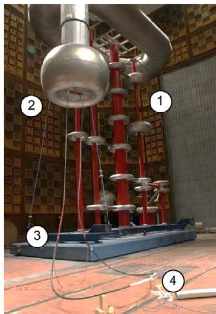
Bild 10.3: Prüfaufbau im Nikola Tesla Labor bei DC-Durchschlagsuntersuchungen eines 6/10-kV-Prüflings, 1: Greinacher-Kaskade, 2: Zentralelektrode, 3: Prüfendverschluss, 4: Heizbereich
