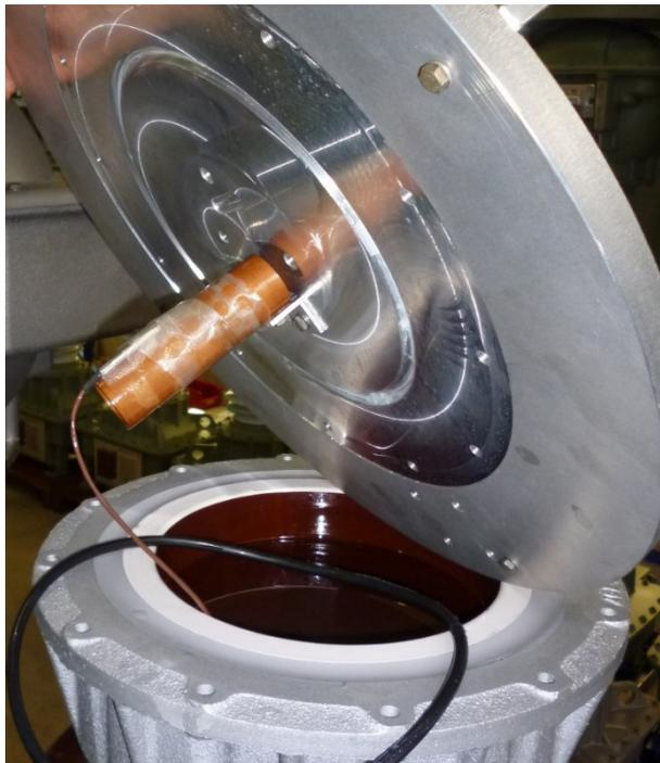
Abbildung 33: Deckel-Blindflansch mit Hartpapier-Trägerrohr für Thermoelement
