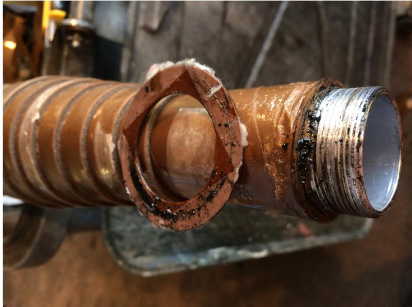
Abbildung 46: Starke Überhitzung im Bereich der Verschraubung des Durchführungsrohres mit der Kernschale des Stromwandlers. Über dieser Schadensstelle befindet sich im Originalzustand ein dicker Isolierpapierwickel.
