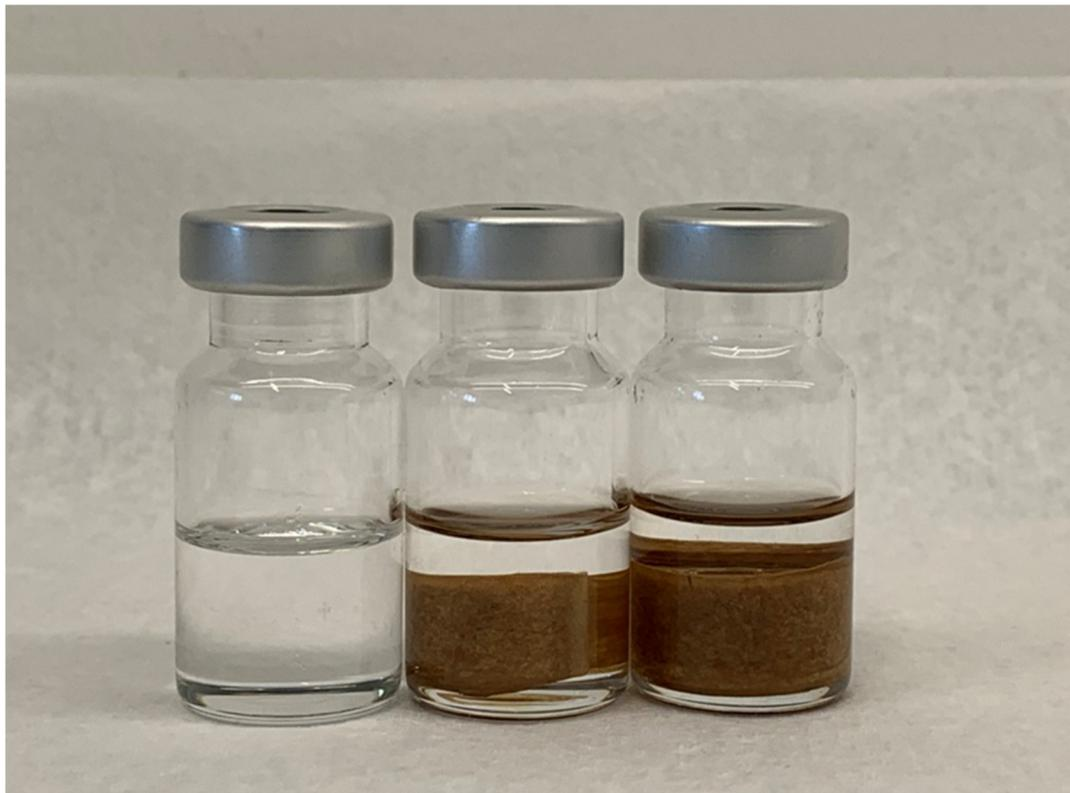
Abbildung 3: Headspace-Proben mit 0 % (Referenzprobe), 11,6 % und 23,1 % Papierzusatz
