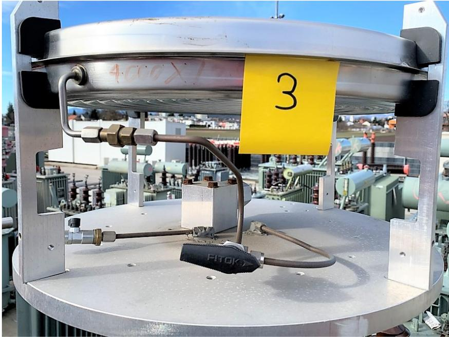
Abbildung 14: Proband 3: Dehnelement mit Dreiwegventil in der Verbindungsleitung zum Wandlerteil
