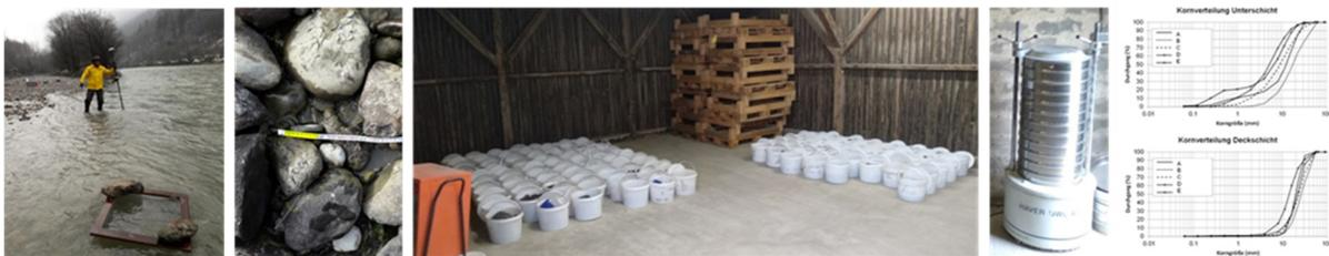
Abbildung 1: Probenahme mit Rahmen und GPS (li.), Probe DS (2.v.li.), abgefüllte Proben im Trockenraum (3.v.li.), Siebturm (4.v.li.), grafische Ergebnisdarstellung der Siebung (re.).
